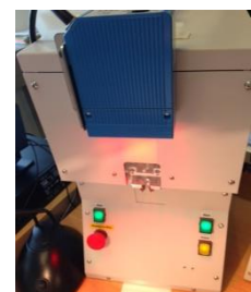
Figur 2 Maskine til at presse prøven ned i røret.
